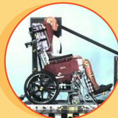
Test de collision satisfaisant la norme WC-19 pour le transport d'occupants
